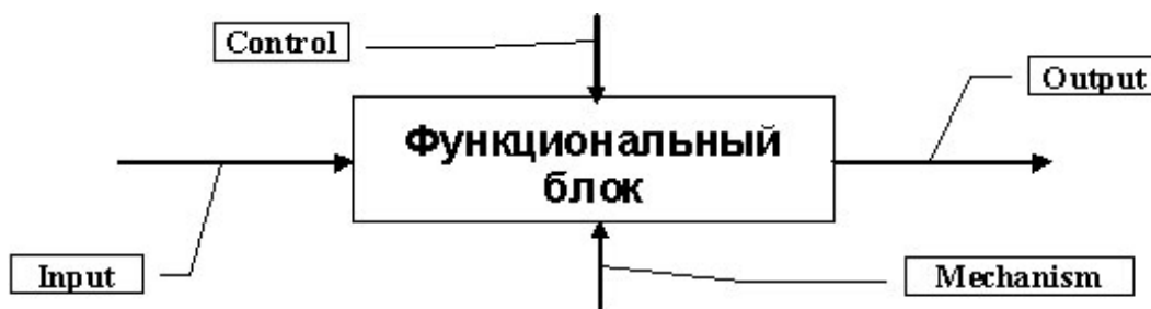
Рис. 5. – Функциональный блок в нотации IDEF0.
